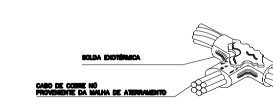
6 SOLDA EXOTÉRMICA TA ESCALA S/E
